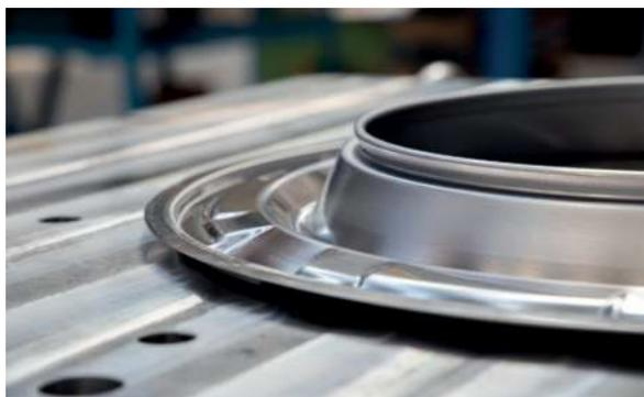
**Stampo progettato e realizzato da Attrezzeria Universal destinato alla produzione di un fondocesto in acciaio inox, settore elettrodomestico.**
